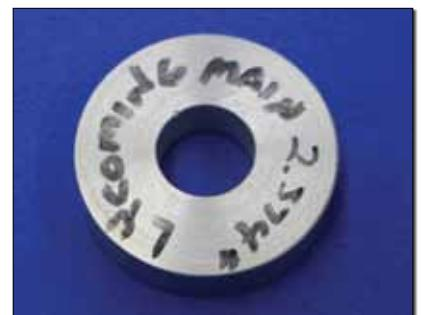
Fig. 14: Crank journal gauge plug.
